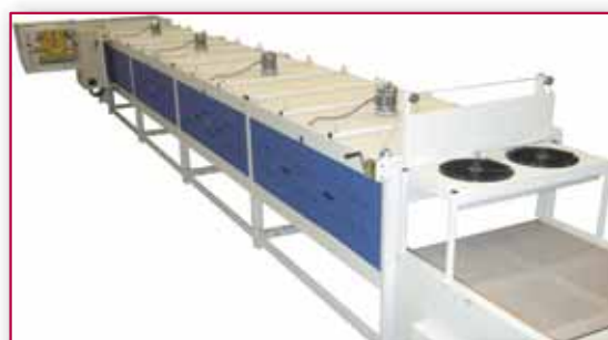
Fours basse température pour encre traditionnelle (250° C)
