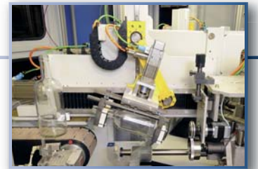
Manipulateur de chargement/déchargement numérique haute cadence.
